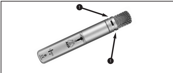
Abb. 8: Hintere Schallein-trittsöffnungen freihalten!
