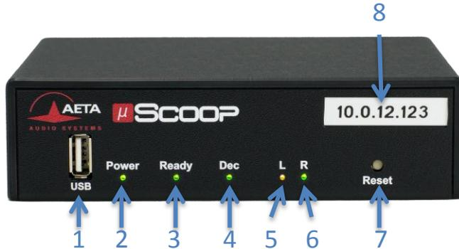
1. **Prise USB** de type A pour connexion d'une clé mémoire, utilisable pour configuration de récupération.
