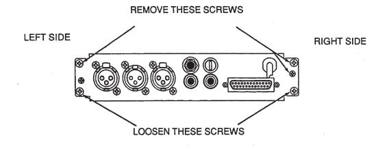
LIFT LEFT SIDE OF TOP COVER, AND SLIDE THE RIGHT SIDE BACK FAR ENOUGH TO CLEAR TAB ON FRONT PANEL BEFORE LIFTING UP.
